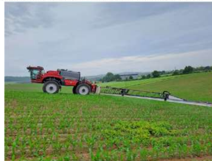
Obr. 17 Provedení plošně diferencované aplikace herbicidních látek postřikovačem Horsch Leeb na pozemcích ROSTĚNICE a.s.
